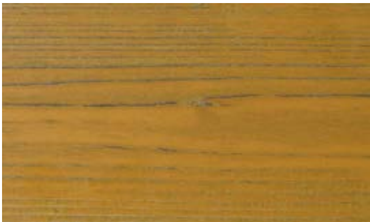
Fig. 2.2 : Stade de dégradation par les intempéries 2
